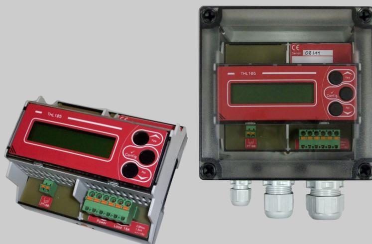
Le THL105 est un thermostat compact, de terrain, destiné à la régulation des câbles et rubans chauffants , permettant la commande de charge résistive jusqu'à 3.5 Kilowatts. La régulation numérique permet d'allier précision et facilité de réglage. La température et la consigne sont affichées sur un large afficheur LCD
